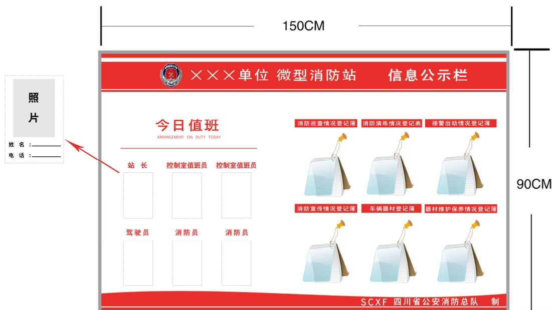
尺寸：150cm\*90cm 材质与制作工艺：不锈钢框架 户外写真覆亚膜裱 10mm pvc 板，3mm 有机玻璃覆面。参考色卡：红 C:0 M:93 Y:84 K:0，白 C:0 M:0 Y:0 K:0。“今日值班”栏的人员配备根据微型消防站实际情况自行调整。设置在公安派出所、社区警务室内的微型消防站色卡应当与所在建筑标识统一。
